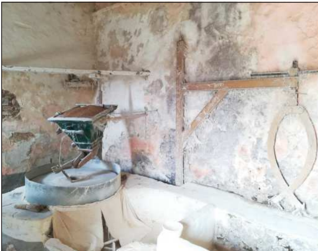
Ilustración 3.- Sala de molienda. Cabria, tolva, piedra volandera, harinal. Molino de Juan Gil, Garganta del Rayo.
