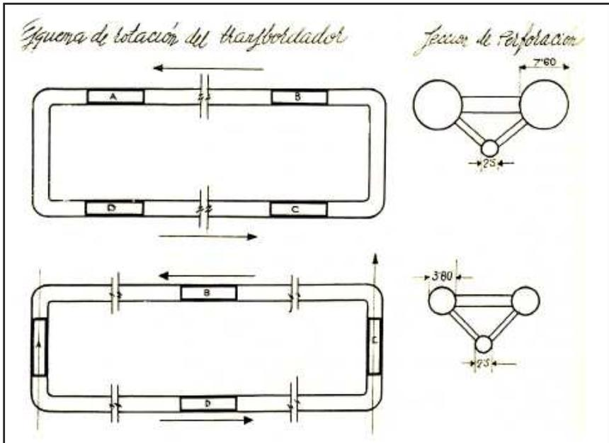
*Esquema de rotación del transbordador propuesto por Goicoechea para el túnel del estrecho de Gibraltar.*
